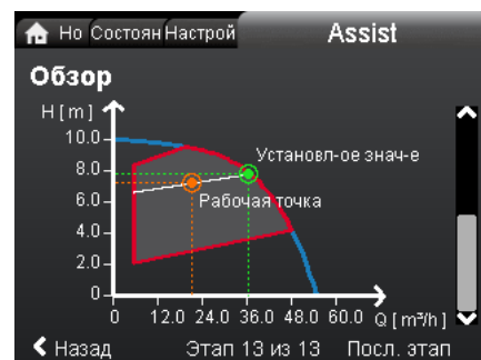
Рис. 8 Пример расчета установленного значения основан на выбранном режиме управления и введенных значениях Q и H.
