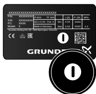
34-сур. Негізгі бастиек бөлігінің фирмалық тақтайшада белгіленуі (зауыттық қондырғы)
