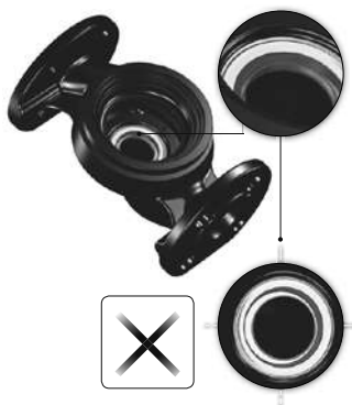
Նկար 17 Խցվածքների սխալ հավասարեցրած համակարգ
