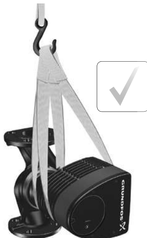
9-сүр. Сорқысманы илип көтөрүүнүн туура ыкмасы
