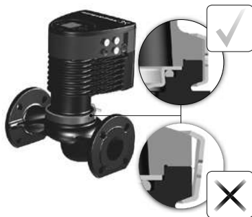
Рис. 18 Закрепление головной части насоса на корпусе насоса
