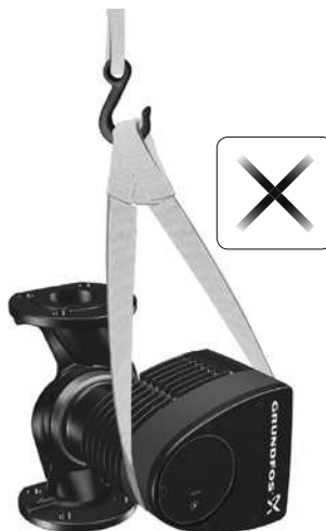
10-сүр. Сорқысманы илип көтөрүүнүн туура эмес ыкмасы
