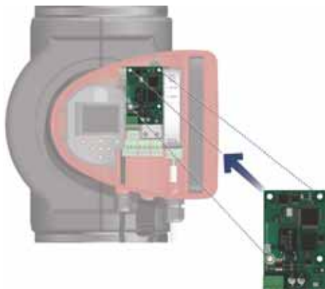
Рис. 65 Расположение модуля SIM
