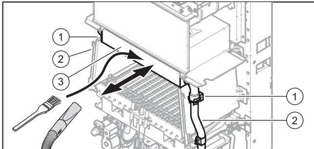
1. Снимите скобы (1) на трубе подающей и обратной линии.
