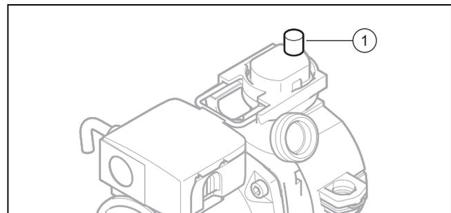
4. Снимите колпачок (1) быстродействующего воздухоотводчика.
