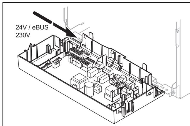
1. Проведите соединительные провода подключаемых компонентов через кабельный ввод слева через нижнюю сторону изделия.
