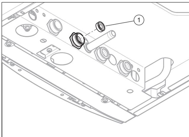
4. Проверьте сетчатый фильтр (1) на отсутствие повреждений.
