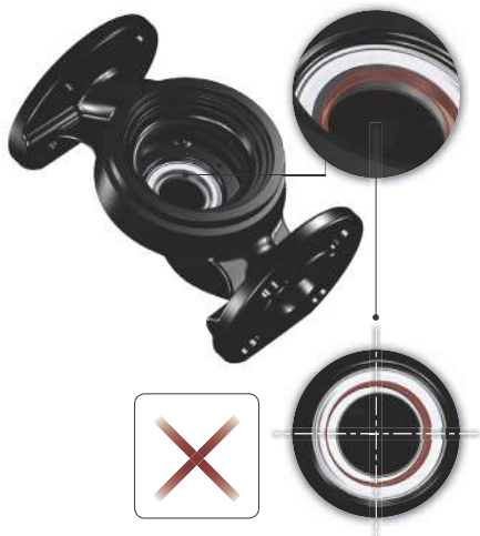
Рис. 12 Неправильно выровненная система уплотнений
