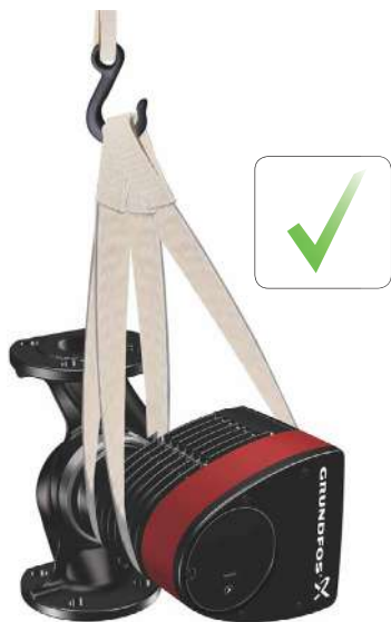
Рис. 5 Правильный способ строповки насоса
