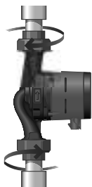
Рис. 3 Монтаж насоса ALPHA3
